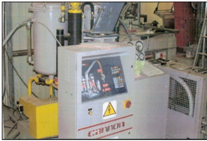
Le mélange du polioli et de l'acétate (pompe Cannon- SAIP) avant injection de la mousse polyuréthane.
