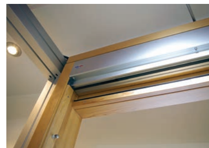
Le nouveau moteur HS-Master Concealed de Ferco est un moteur à translation magnétique : entièrement installé en partie haute du dormant, il ne requiert aucune alimentation électrique de l'ouvrant. Il est actionné par interrupteur mural, contacteur à clef, télécommande, fonction push-and-go en donnant une poussée au vantail, par poignée.
