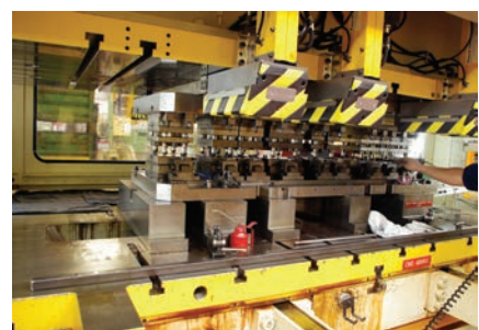
Lorsqu'une machine n'est pas en production, c'est le moment de l'entretenir ou d'améliorer sa programmation ou de tester de nouveaux outils. Cette machine redresse du fil d'acier. Il passe dans l'outil et se forme étape par étape.
