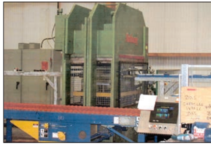
Profileuse Bradbury produite au Kansas, sortant des panneaux "à cassettes" en chêne doré... aujourd'hui passés de mode.
