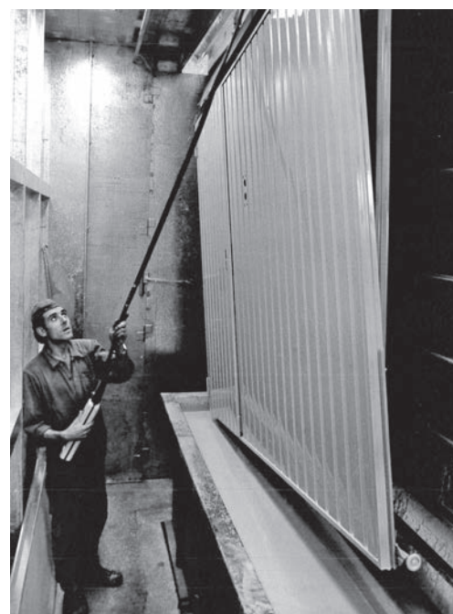
Soferba , dans les années 80, avec deux techniques novatrices pour l'époque et aujourd'hui dépassées : le soudage par points et la peinture par trempage.
