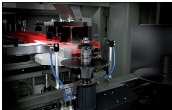
Le centre d'usinage Quadra L2 est équipé également d'une tête de fraisage en bout avec un groupe de fraises à vitesse de rotation variable jusqu'à 8 000tr/min et de changement rapide du groupe de fraises par commande pneumatique.
