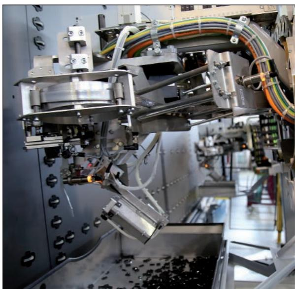
La ligne Velocity Plus dispose de deux applicateurs d'écartement qui appliquent les écarteurs sur la feuille de verre sans tension et avec précision, pour des durées de cycle rapides et une qualité parfaite.
