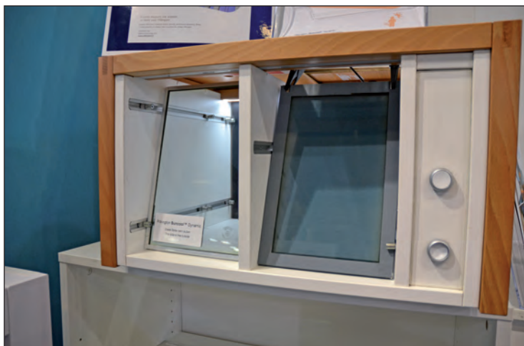
à gauche le verre Suncool Dynamic, et à droite le même verre chauffé.
