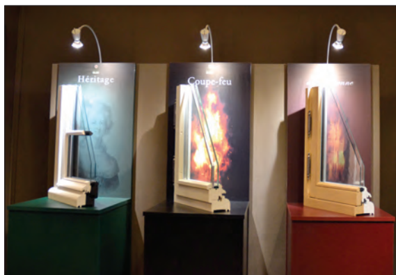
Les trois gammes des menuiseries Helleux : Héritage, à jeu de recouvrement de 12 mm, Coupe-feu, à jeu de recouvrement de 4 mm, à l'Ancienne, avec mouton et gueule de loup.
