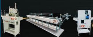
Pose de joints EPDM, pose de joints brosses, protection de profils.
