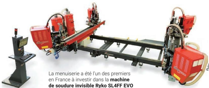
La menuiserie a été l'un des premiers en France à investir dans la machine de soudure invisible Ryko SL4FF EVO
