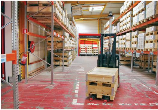
**L'ensemble du stock de produits finis** est géré par des AGV – Automated Guided Vehicle – en toute autonomie, sans personnel. Il ne faut qu'une heure entre la fabrication d'une pièce et le moment où elle est prête à être vendue.
