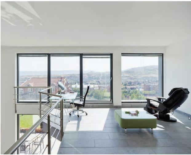
**Rehau utilise Raufipro**, sa matière de synthèse chargée de fibres de verre courtes, notamment dans sa gamme Neferia : 40 décors et 200 couleurs RAL. Grâce au Raufipro, les châssis Neferia de Rehau n'ont plus besoin de renforts en métal dans 90 % des cas. En association avec un double vitrage, les valeurs  $U_w$  peuvent atteindre  $1,1 \text{ W/m}^2\cdot\text{K}$  et jusqu'à  $0,60 \text{ W/m}^2\cdot\text{K}$ , avec un triple vitrage.
