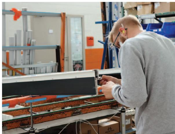
Pose de seuil aluminium sur un châssis de porte et réalisation de l'étanchéité.
