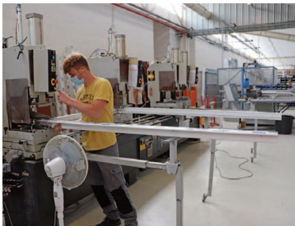
Zone de traitement des portes et des ouvrants et dormants à meneaux-traverses, assemblés mécaniquement. Environ 2 200 portes sont fabriquées par an. Ci-dessus : ébavurage du U d'une future porte.
