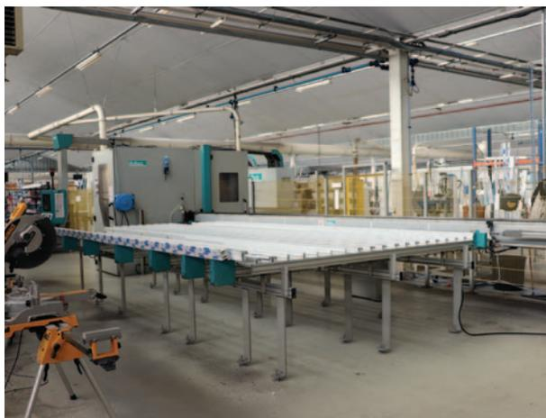
Zone de débit usinage : un unique centre d'usinage Dubus est utilisé pour tous les ouvrants et dormants.
