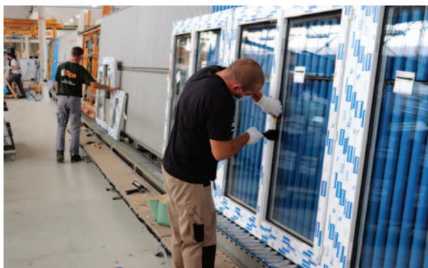
Zone de vitrage et parclosage : l'autocontrôle est de rigueur tout au long du process. Un contrôle en fin de ligne, mis en place en juillet dans le cadre du plan qualité de 2021, commence à porter ses fruits.
