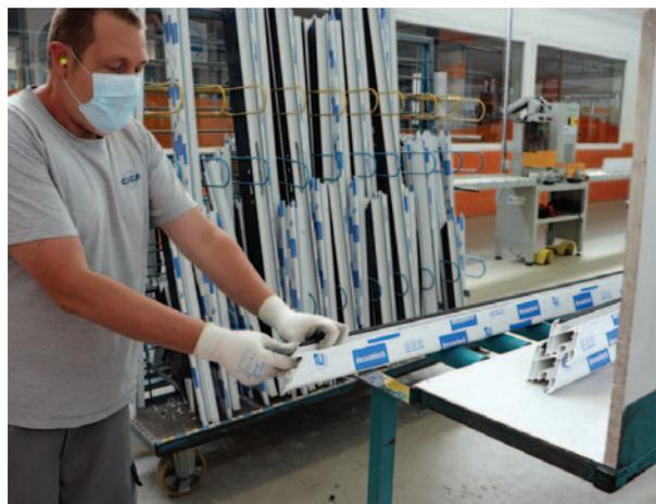
Pose des renforts avant leur vissage automatique. Le pré-perçage des renforts est proposé en option pour la rénovation.
