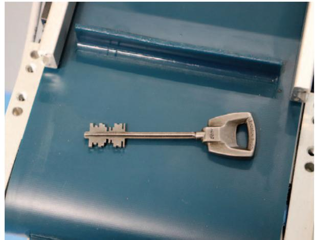
Le design de la nouvelle clé permet une manœuvre plus souple grâce à une extrémité chanfreinée. Cette clé de présérie est mate ; les futures clés seront brillantes.
