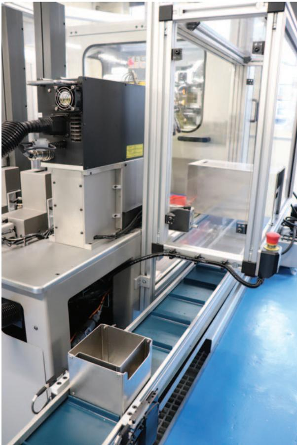
La clé achevée est déposée dans un chariot qui transite sur un tapis roulant. Deylta fabrique une clé en 90 secondes : la productivité des clés est légèrement augmentée.
