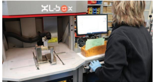
Parachèvement des cylindres par l'ajout d'une enveloppe, qui est sertie. Les enveloppes varient avec le type de serrure.
