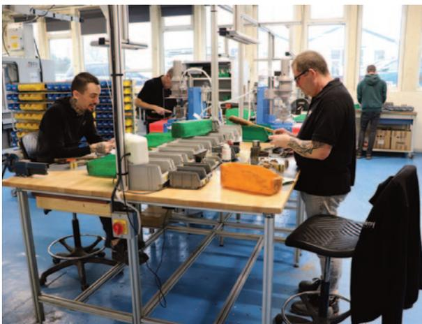
Le réglage est manuel et minutieux sur les cinq postes d'ajustage des cylindres montés. L'autocontrôle est réalisé à tous les stades de la fabrication.
