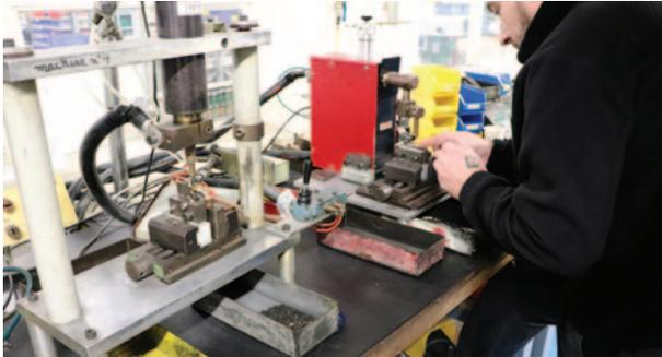
Sur ce poste, les clavettes classiquement découpées en tôlerie sont soudées par points et ébavurées manuellement.
