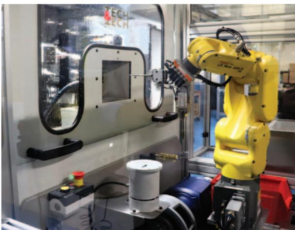
Le bras robotisé prend une ébauche, la positionne dans la zone de marquage au laser, puis l'introduit dans la zone d'usinage confinée dans une enceinte.
