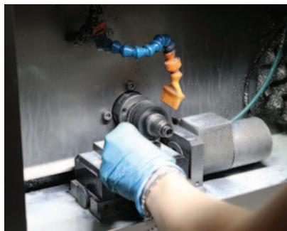
Chaque modèle de clé est taillé en assemblant sur une machine à usiner 40 à 50 disques de fraise dans l'ordre défini par l'organigramme. La clé étant réversible, l'usinage se fait donc de chaque côté du panneton. Il s'achève par le chanfreinage du nez. L'opération demande donc plusieurs manipulations par clé.
