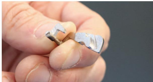
Clavette réalisée en MIM, avec tige soudée au laser. Des détails supplémentaires renforcent la sécurité du cylindre. Celui-ci ne peut être manœuvré que par la bonne clé, seule à pouvoir ouvrir le passage au travers du cylindre par l'enclenchement d'un jeu de mouvements entre les clavettes. La clé peut ensuite manœuvrer la serrure qui sera située derrière ce filtre.
