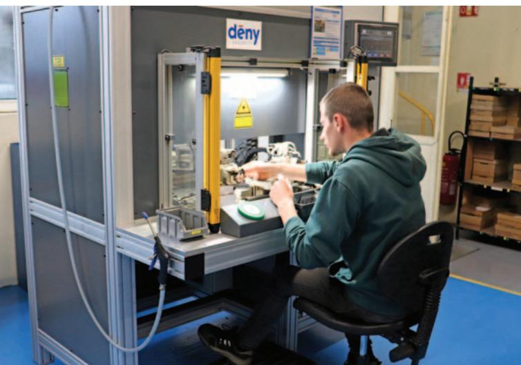
L'assemblage des clavettes s'effectue depuis juillet 2021 à l'aide d'une machine à souder laser qui permet d'assembler les touches automatiquement à des positions différentes en fonction de la variure du cylindre.
