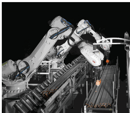
KASTOpick bar utilise neuf millions de points de mesure, identifiés par un capteur 3D et le logiciel associé, pour assurer aux deux robots une préhension entièrement automatique et sûre des produits longs.
