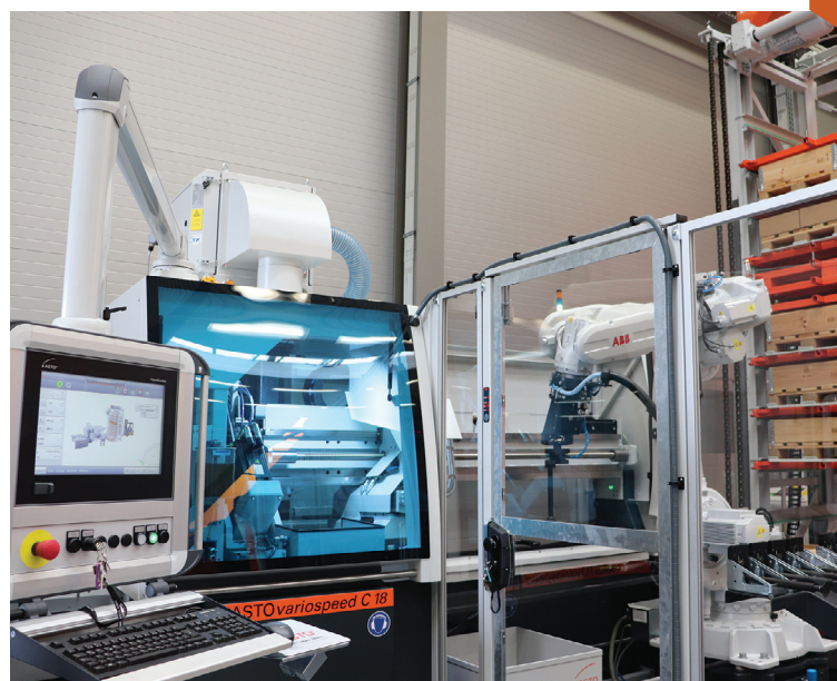
Dans le showroom, la scie KASTOvariospeed C18 associée au magasin KASTOsort Tower.
