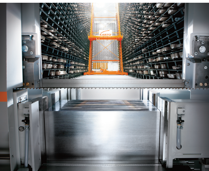
KASTOunicompact, système de rayonnages en nid d'abeille entièrement automatique, comporte des milliers de rangements pour les cassettes de stockage.
