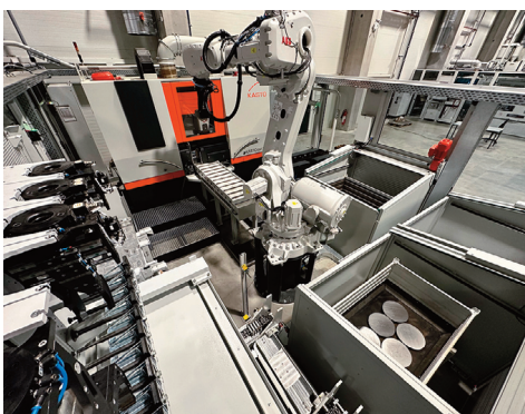
14 scies KASTOvariospeed C18 travaillent dans cette usine très automatisée, associées chacune à un robot ABB.
